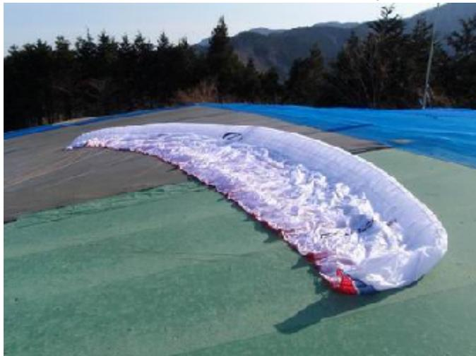
翼端のはね上がりは、通常のグライダーはスタビのラインが他のラインとカスケードして、いわゆる翼の一番端に付いていますが、R10では、一番翼端ではなく、1セル内側に入ったところにラインが取り付けられており、翼端が少し反り上がるような特徴的な形となっているようです。おそらくこの翼形が、翼端渦をうまく処理している?!のではと思います。これからの、トレンドになりそうな気がします。
